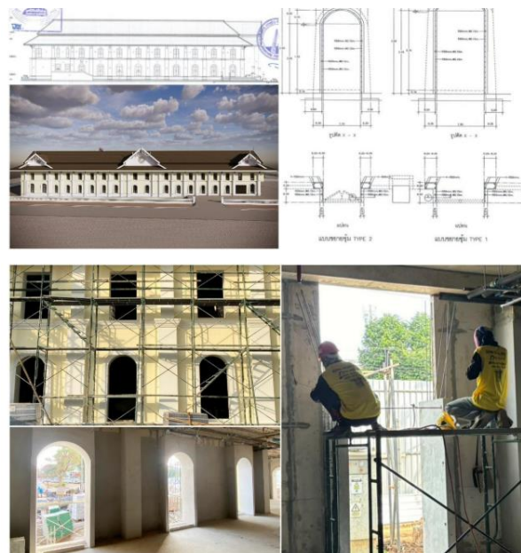
รูปแบบซุ้มหน้าต่าง และการติดตั้งจริง
