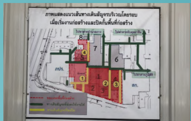
การติดตั้งป้ายจราจรและการจัดทำผังเส้นทางสัญจรรอบพื้นที่ก่อสร้าง
