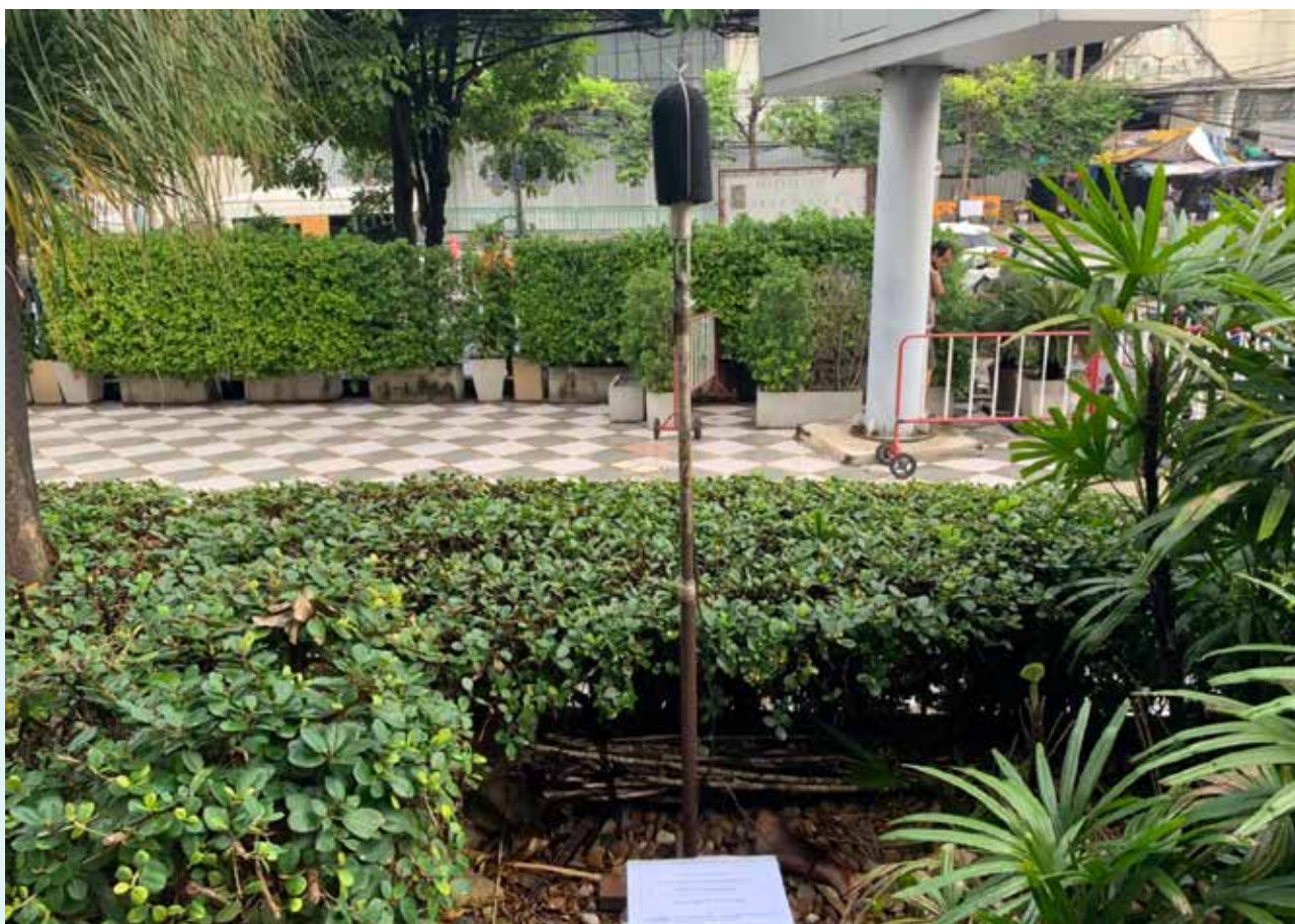
การติดตั้งเครื่องตรวจวัดระดับเสียงภายในพื้นที่ก่อสร้าง
